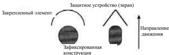
Защитный экран определяется как закрепленный неподвижный элемент, используемый в качестве рассекателя, уменьшающего сопротивление ветра при движении велосипедиста.
